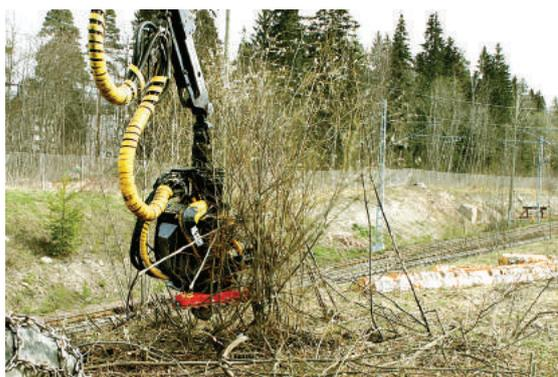
La lame de débroussaillage n'est pas sensible aux pierres et il n'y a pratiquement aucun besoin d'affilage.
