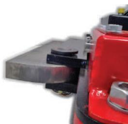
La lame de débroussaillage est facile et rapide à monter et à démonter. L'équipement inclut une unité de montage rapide à souder sur le châssis.
